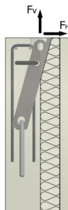
Sandwichplaatanker SA-SP - Draagvermogen, installatieafmetingen
